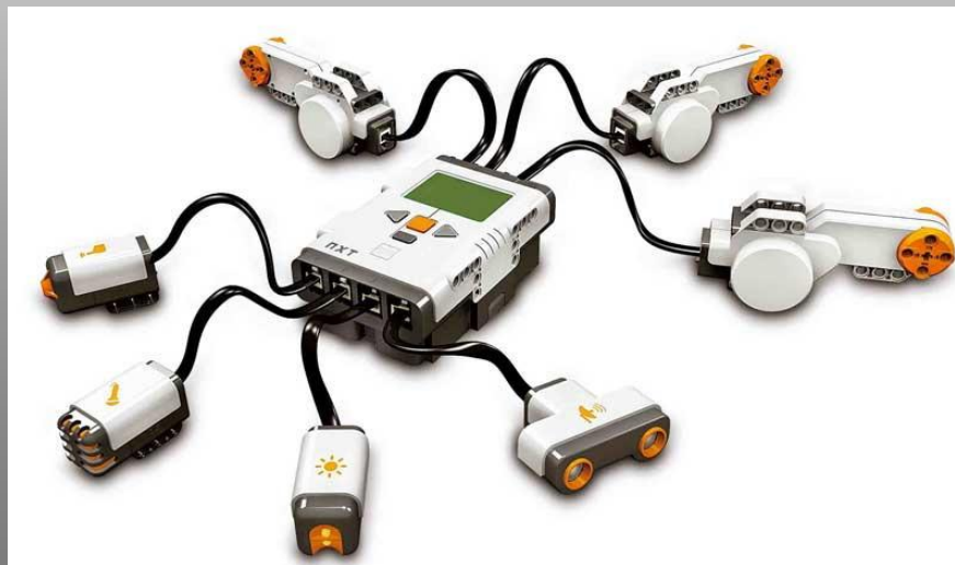
Obr. 2 Inteligentní LEGO® NXT kostka a připojení senzorů
